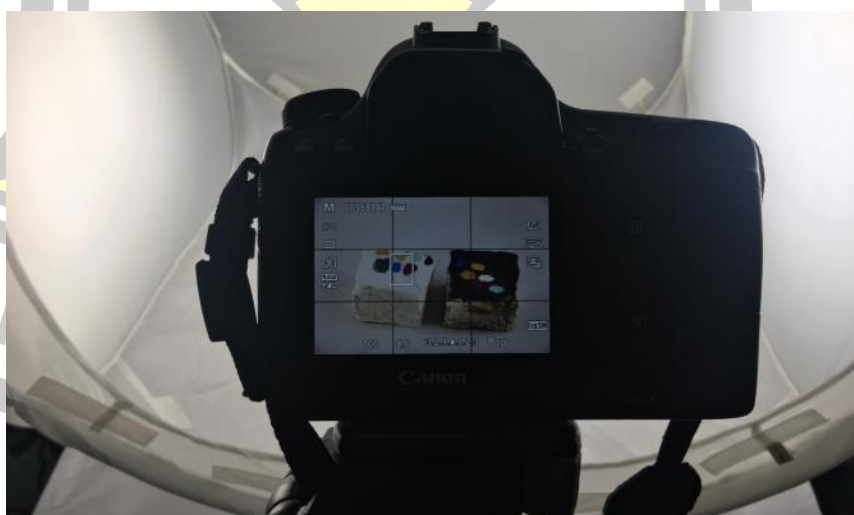
ภาพประกอบ 106 การถ่ายภาพแผ่นปูนทดสอบสีด้วยเทคนิค CVS
