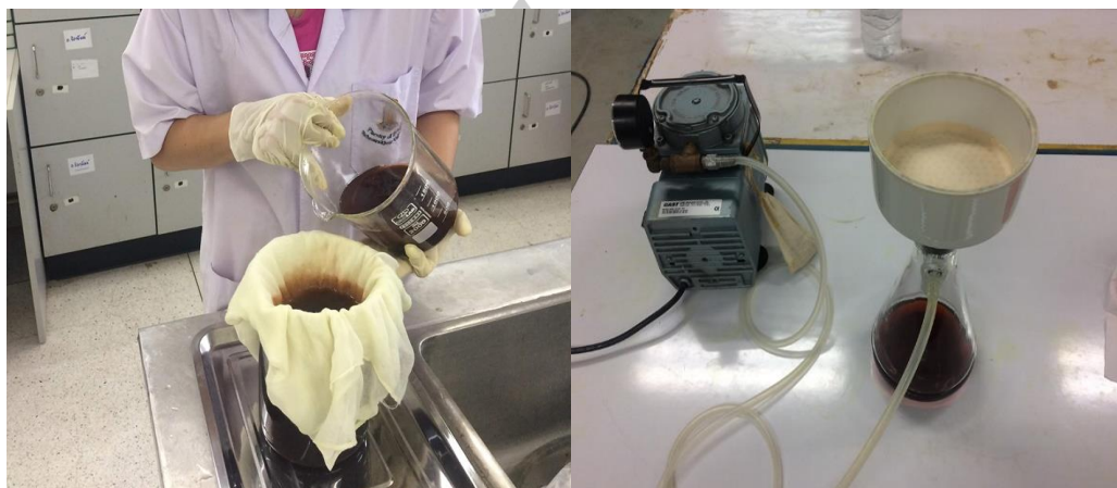
ภาพประกอบ 20 การสกัดสารด้วยตัวทำละลายเอทานอล 50% และเอทานอล 95%
