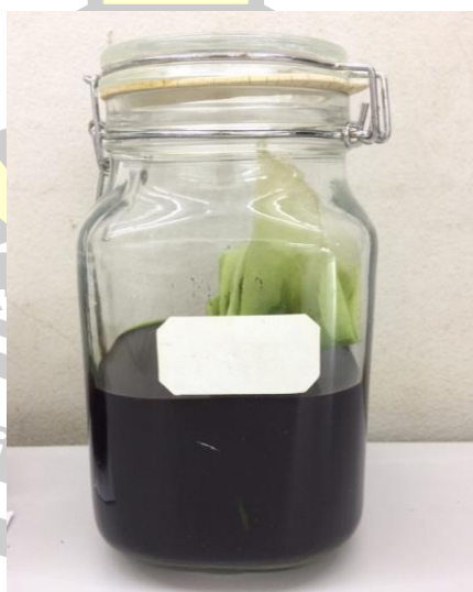
ภาพประกอบ 19 การสกัดสารด้วยตัวทำละลายเอทานอล 50% และเอทานอล 95%
