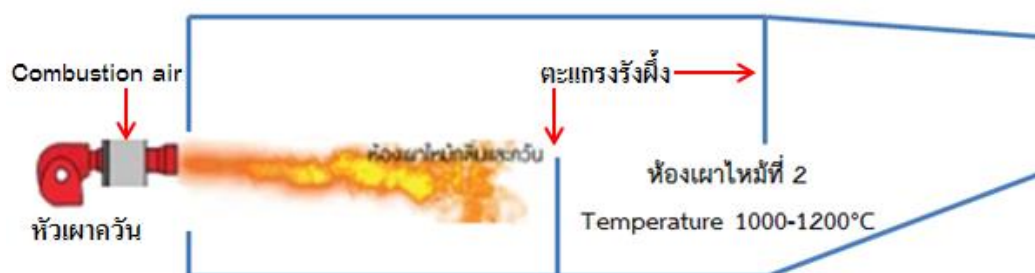
ภาพประกอบ 58 โครงสร้างภายในของเตาเผาไหม้ที่ 2
