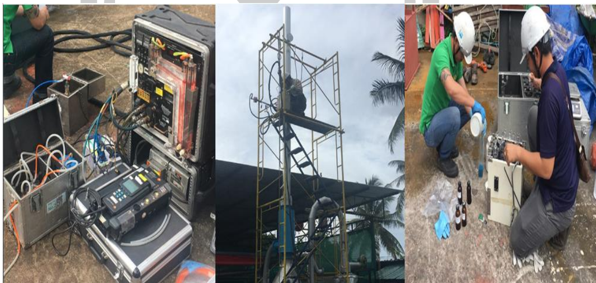
ภาพประกอบ 79 การตรวจวัดคุณภาพอากาศที่ปลายปล่องระบายของเตาเผา
