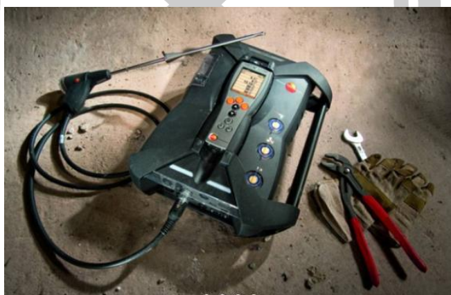
ภาพประกอบ 78 เครื่องวัดก๊าซ Testo 350 สำหรับวัดก๊าซ CO, NO 2 , SO 2
