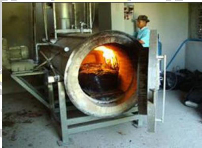
ภาพประกอบ 29 เตาเผาแบบหมุน (Rotary kilns) [11]
