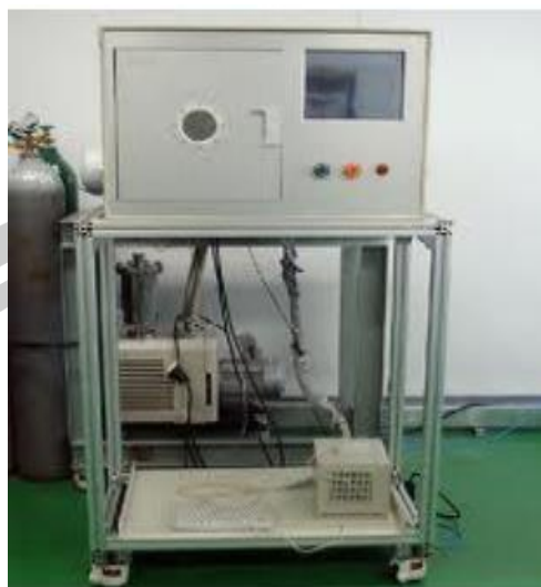
ภาพประกอบ 25 การทำลายเชื้อด้วยคลื่นไมโครเวฟ [11]
