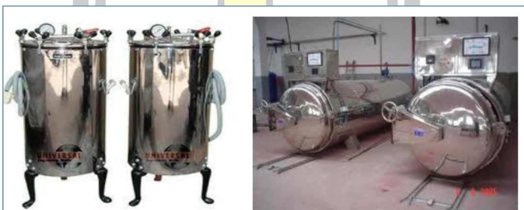
ภาพประกอบ 24 การกำจัดขยະติดเชื้อด้วยไอน้ำ (Autoclaves) [11]
