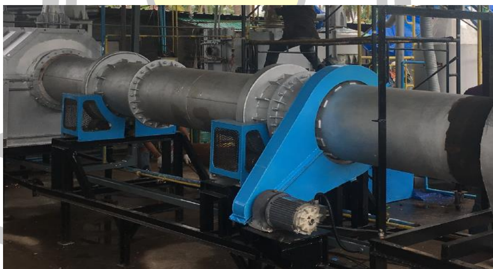
ภาพประกอบ 60 ระบบขับเคลื่อนเตาเผา
