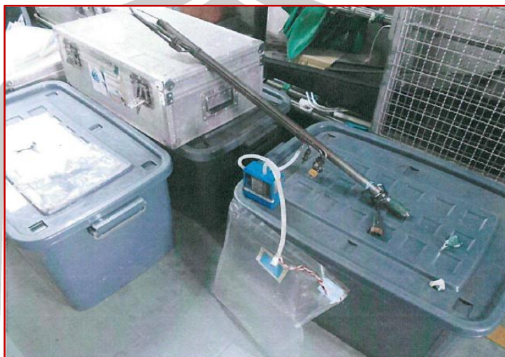
ภาพประกอบ 73 ชุดตรวจวัดแก๊สคาร์บอนมอนอกไซด์ (CO) ในปล่องระบาย
