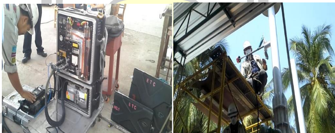
ภาพประกอบ 59 การตรวจวัดคุณภาพอากาศที่ปลายปล่องระบายของเตาเผา
