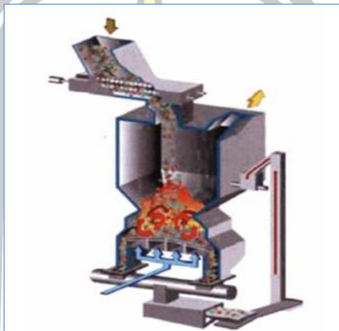
ภาพประกอบ 7 เตาเผาแบบฟลูอิดไดซ์เบด (Fluidized Bed)
