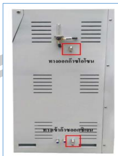
ภาพประกอบ 33 ก๊าซโอโซนออกไปยังชุดผสมก๊าซโอโซน (Mixing Unit)
