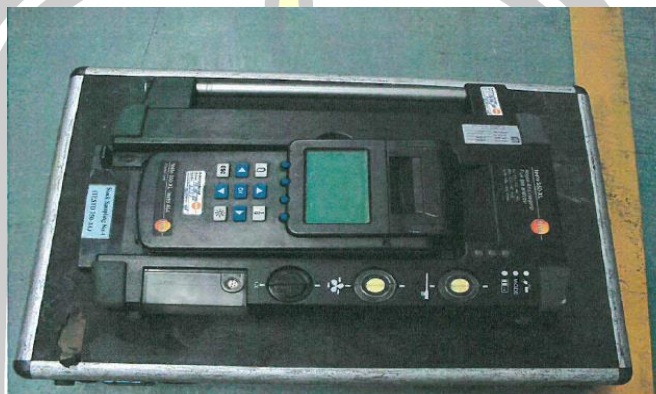
ภาพประกอบ 56 ชุดตรวจวัดประสิทธิภาพการเผาไหม้ในปล่องระบาย (Flue Gas Analyzer)
