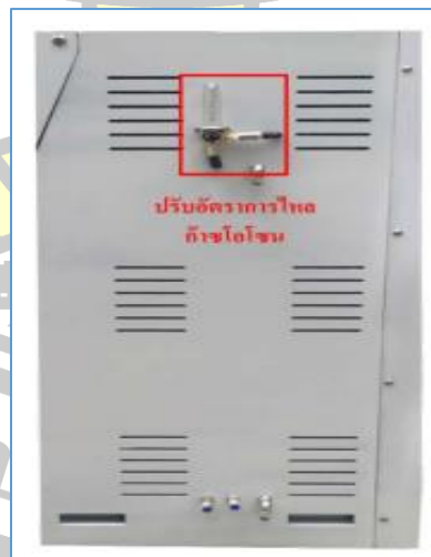
ภาพประกอบ 37 ปรับอัตราการไหล เพื่อจ่ายเข้า Ozone Generator
