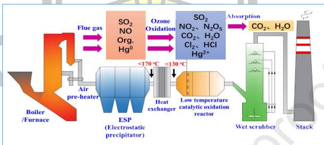
ภาพประกอบ 16 รูปแบบเตาเผาขยะที่ประยุกต์เทคโนโลยีโอโซนเพื่อบำบัดก๊าซไอเสียกับเตาหลอม
