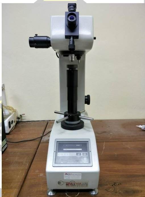
ภาพประกอบ ค.2 เครื่องทดสอบความแข็งแบบ Macro- Vickers
