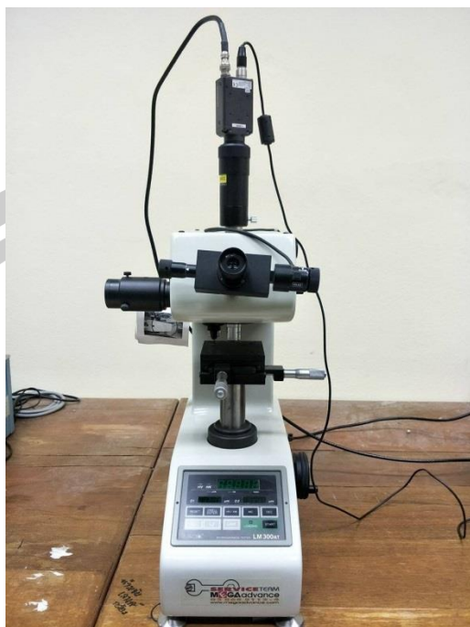
ภาพประกอบ ค.3 เครื่องทดสอบความแข็งแบบ Micro- Vickers
