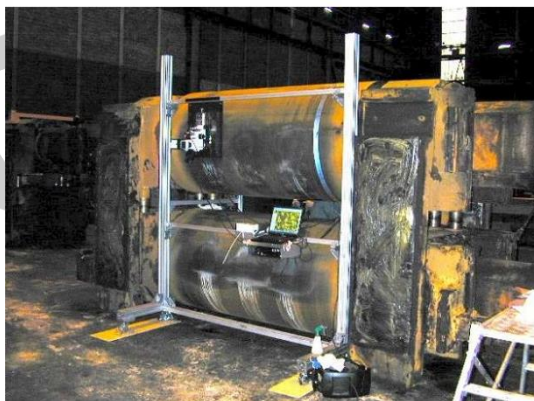
ภาพประกอบ 2.36 สึกหรอของลูกรีดในกระบวนการรีดร้อน [2]
