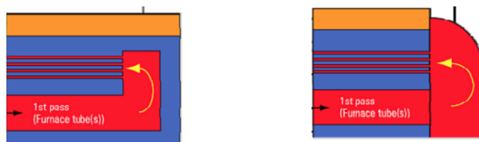
ภาพประกอบ 2.4 ห้องกลับไฟ (a) แบบหลังเปียก (b) แบบหลังแห้ง [1]
