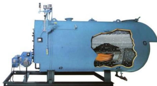
ภาพประกอบ 2.6 หม้อน้ำแบบท่อไฟ 3 กลับ หลังเปียก [1]
