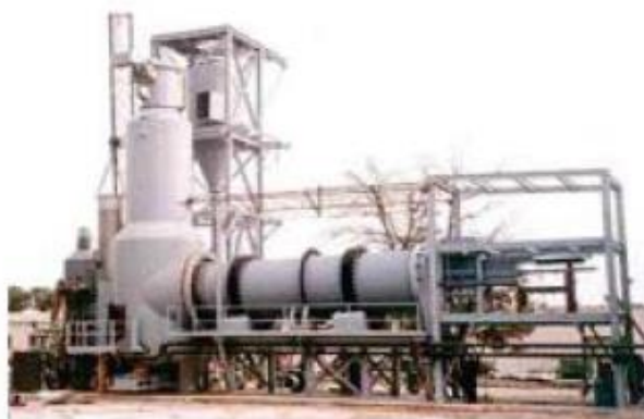
ภาพประกอบ 5 เตาเผาแบบหมุน (Rotary Kiln Incinerator) [2]
