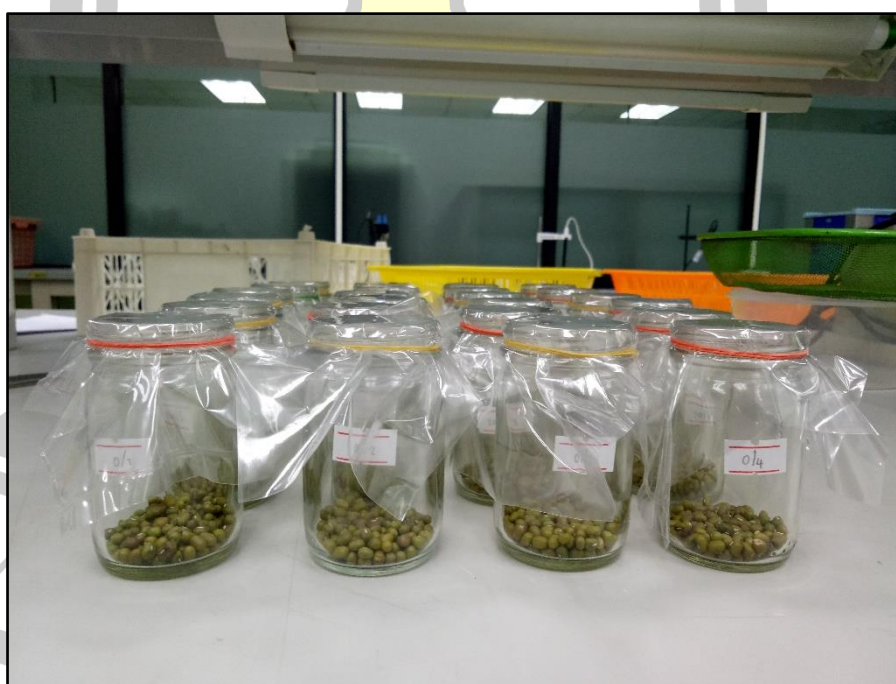
ภาพภาคผนวก 12 ข ผังการวางขวดการทดสอบประสิทธิภาพทางการรมยับยั้งการวางไข่และการยับยั้งออกเป็นตัวเต็มวัยของด้วงถั่วเขียว
