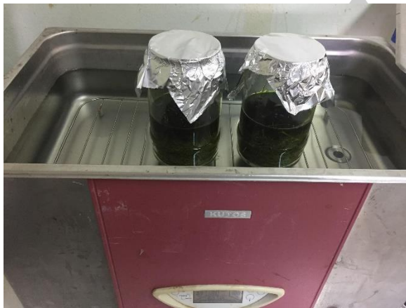
การสกัดสารจากหญ้าไทรและหญ้าปราบด้วยตัวทำละลายเอทานอล 80% (sonicator) และการต้มด้วยน้ำ (decoction)
