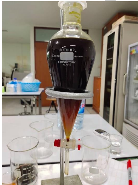
ขั้นตอนการสกัดแยกสารด้วยตัวทำละลาย dichloromethane
