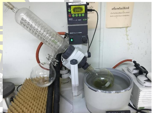
กรองด้วยเครื่องกรองสุญญากาศแล้วนำไประเหย โดยใช้เครื่อง evaporator แล้วนำไปทำแห้ง โดยใช้เครื่อง freeze dry
