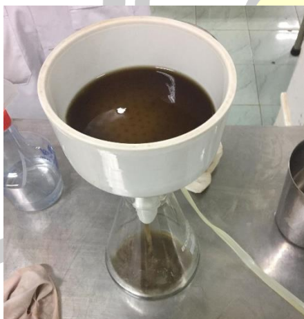
กรองด้วยเครื่องกรองสุญญากาศแล้วนำไประเหย โดยใช้เครื่อง evaporator แล้วนำไปทำแห้ง โดยใช้เครื่อง freeze dry
