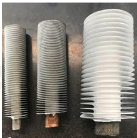
ภาพที่ 15 การติดตั้งครีบทามขวาง
