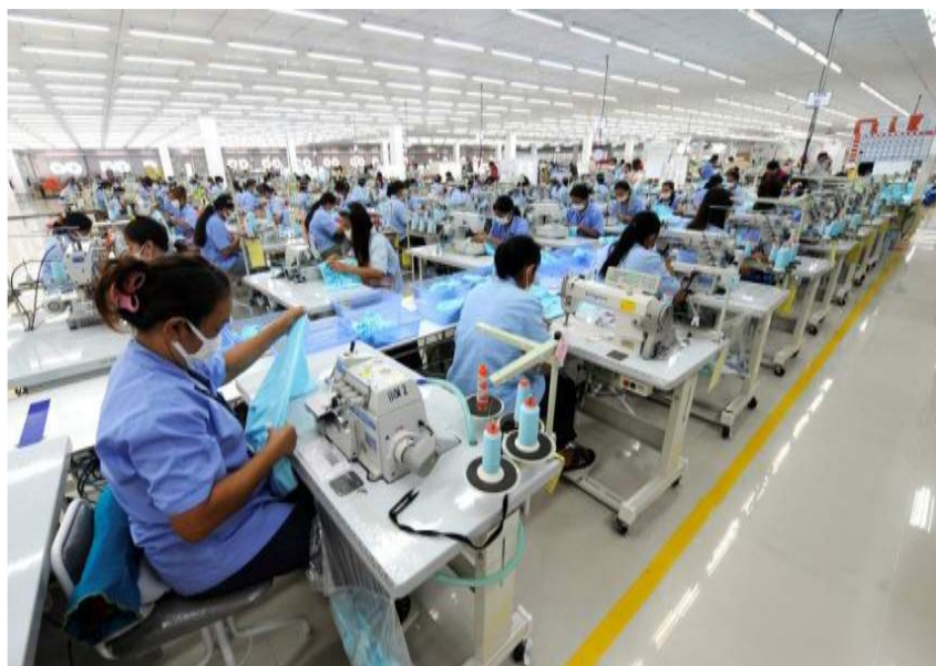
ภาพประกอบ 4 สายการประกอบเย็บเสื้อผ้าโรงงานกรณีศึกษาเป็นการผลิตแบบสินค้าชนิดเดียว
