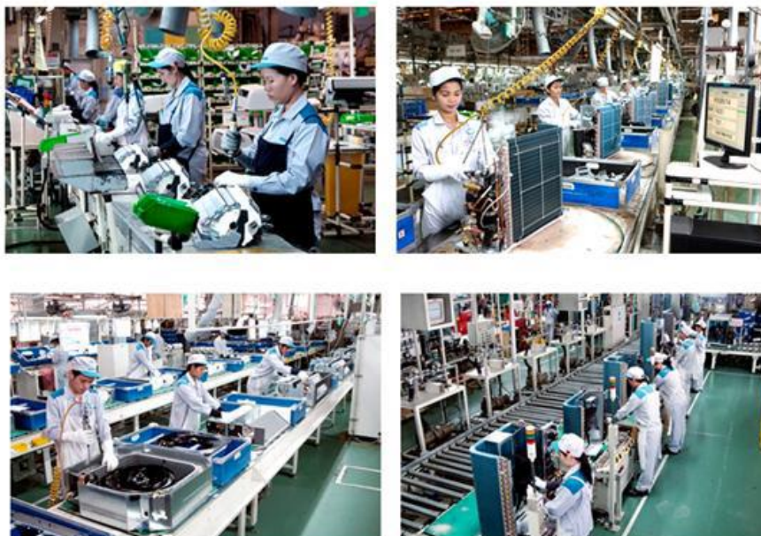
ภาพประกอบ 6 สายการประกอบเครื่องปรับอากาศที่มีความหลากหลายของรุ่น เป็นการผลิตสินค้าแบบผสม
