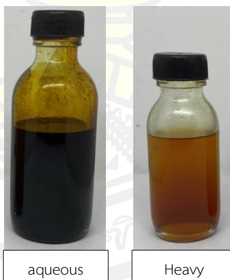
ภาพประกอบ 42 ไบโอออยล์ที่ได้จากการกระบวนการไฟโรไลซิส
