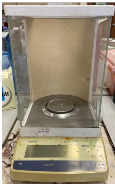
ภาพประกอบ 31 เครื่องชั่งยี่ห้อ mettler toledo รุ่น AB204-S
