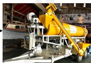
3. อบแห้งด้วยเครื่อง อบแห้งอิน ฟราเรดแบบ ถ้งหมุน 1- 2 ชั่วโมง
