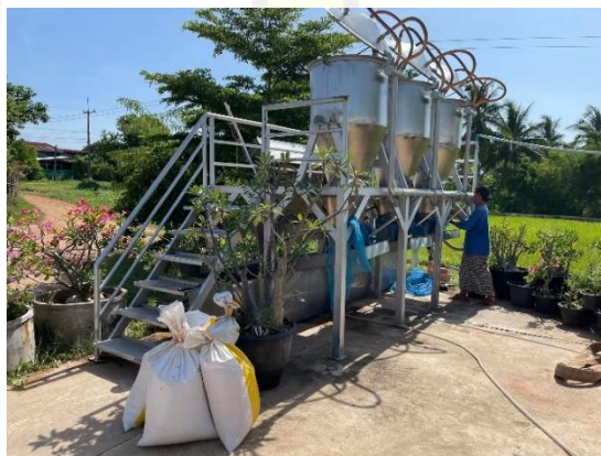
ภาพประกอบ 3.9 เครื่องแช่และเพาะงอกข้าวเปลือกในขั้นตอนเดียว
