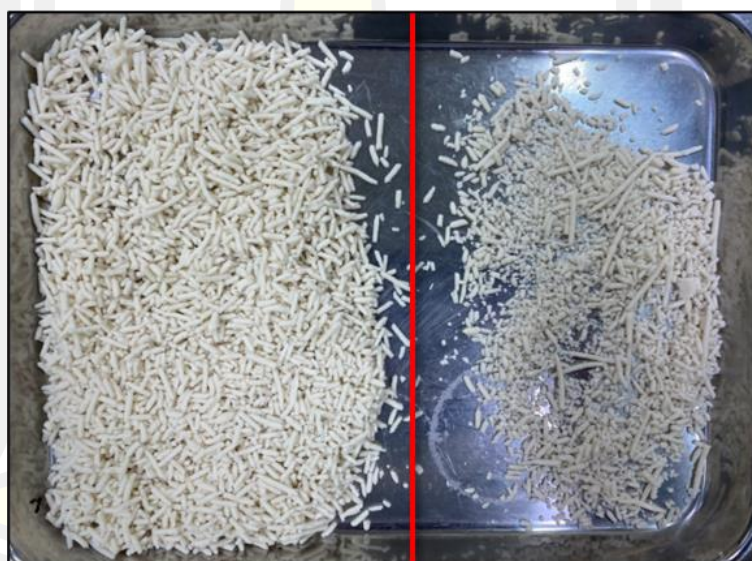
ก) ลักษณะเม็ดข้าวบุกที่ใช้ใบมีดตัดโค้งหน้าตัดขึ้นรูป
