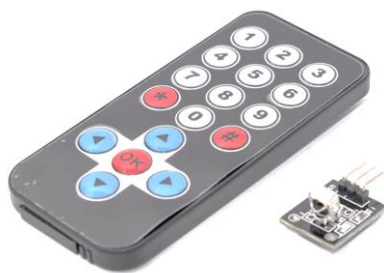
ภาพประกอบ 30 รีโมทคอนโทรลและตัวรับสัญญาณอินฟราเรด
