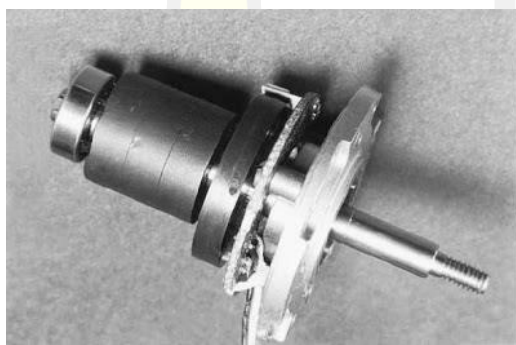
ภาพประกอบ 13 Rotor of a BLDC Motor [31]
