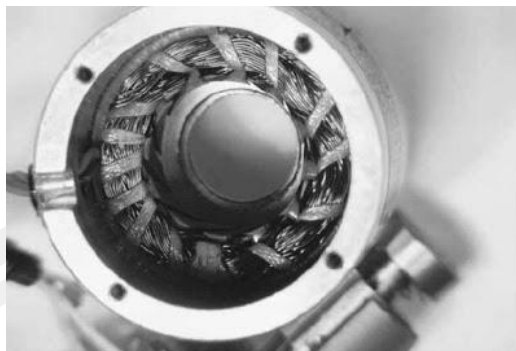
ภาพประกอบ 12 Stator of a BLDC Motor [31]
