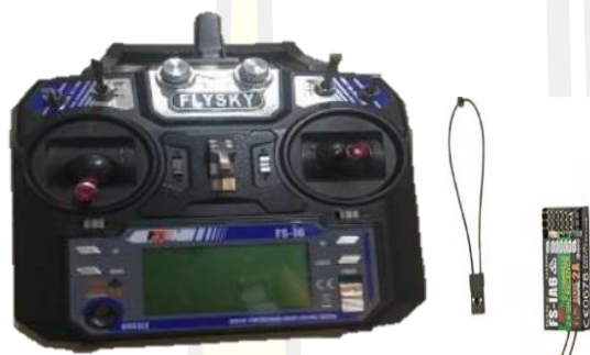
ภาพประกอบ 31 รีโมทคอนโทรลและรีซีฟเวอร์สัญญาณวิทยุ [44]
