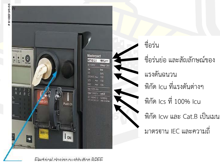
ภาพประกอบ 22 การทำงานของชุดควบคุมของ ACB
