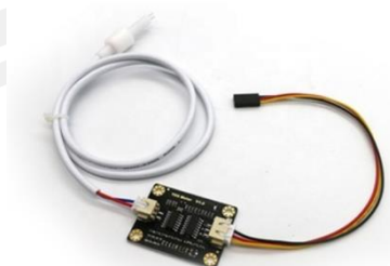
ภาพประกอบที่ 3.6 เซนเซอร์วัดค่าการนำไฟฟ้าของน้ำ[72]
