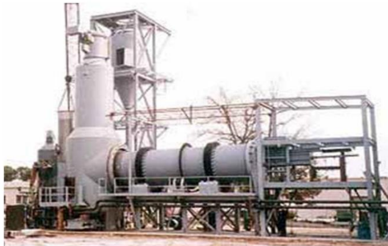
ภาพที่ 21 เตาเผาแบบหมุนที่ติดตั้งใช้งานจริง
