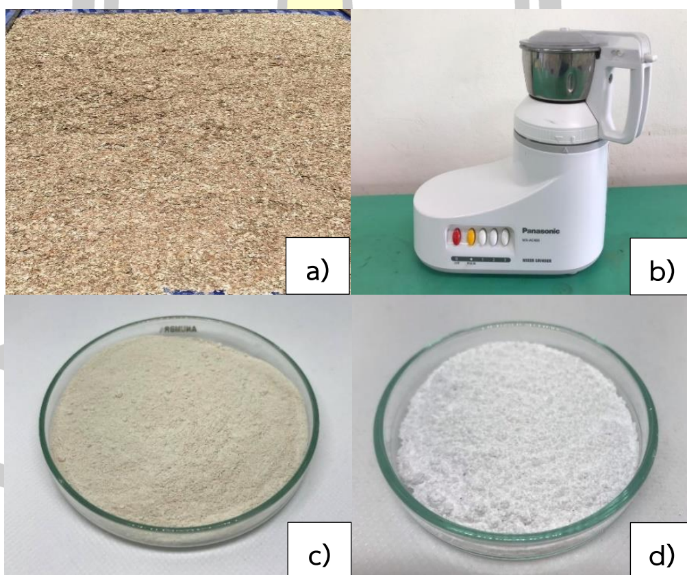
ภาพที่ 40 a) เปลือกไข่ไก่ที่ผ่านการล้างและทำความสะอาด b) เครื่องปั่น c) ผงเปลือกไข่ไก่ d) ผงเปลือกไข่ไก่ที่ผ่านการแคลไซน์ (แคลเซียมออกไซด์)
