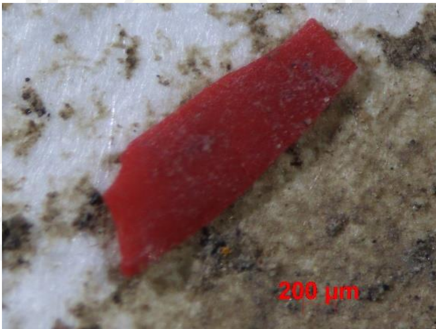
ภาพที่ ข-5 ลักษณะไมโครพลาสติกที่รูปร่างไร้รูปแบบสีแดง
