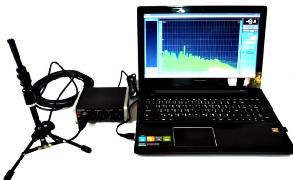
ภาพประกอบที่ 74 เครื่องวิเคราะห์ความถี่เสียง
