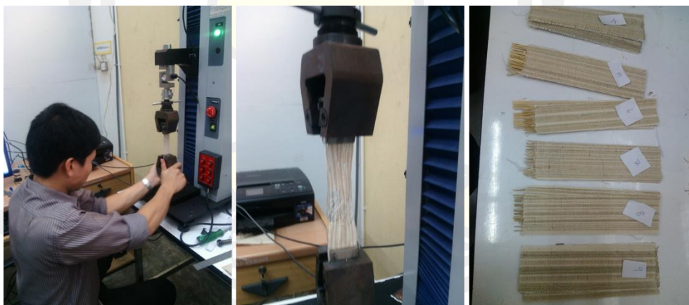
ภาพประกอบที่ 50 ทดสอบด้วยเครื่องวัดแรงดึง รับน้ำหนัก/แรงฉีกขาด การทดสอบทางฟิสิกส์ (แรงดึง, แรงฉีกขาด) วัสดุเป็นผืน (เทคนิคการทอ)
