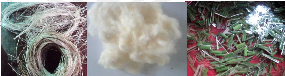
ภาพประกอบที่ 47 วัตถุดิบกากกล้วย ปุยฝ้าย ลำต้นกกมาย่อยด้วย ทุบ แช่
