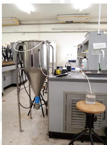
รูปภาพ 16 การติดตั้งชุดทดลองระบบอัลตราฟิลเตรชันกับถังปฏิกรณ์
