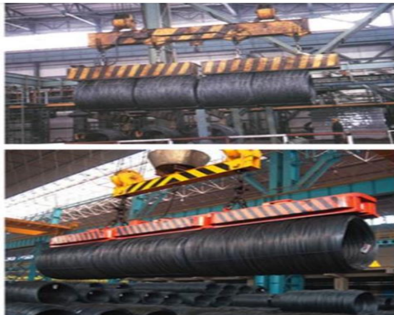
ภาพประกอบ 32 ภาพการนำสนามแม่เหล็กไปใช้ในงานอุตสาหกรรม
