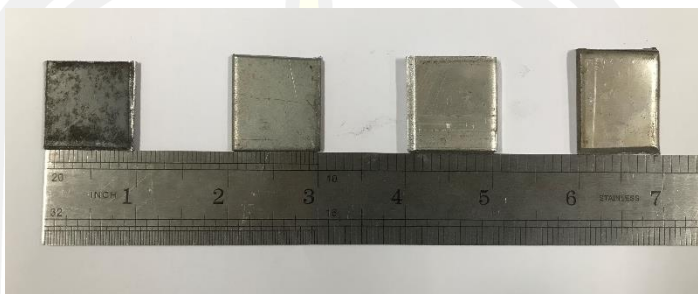
ภาพประกอบ 34 ชิ้นทดสอบที่ใช้ในการยกด้วยหัวแม่เหล็กไฟฟ้า
