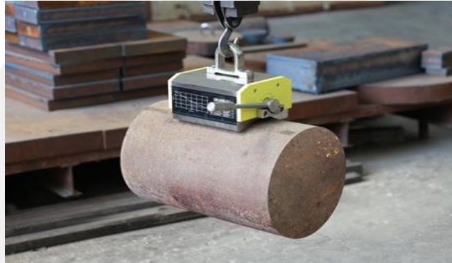
ภาพประกอบ 29 การประยุกต์ใช้หัวแม่เหล็กยกในงานอุตสาหกรรม
