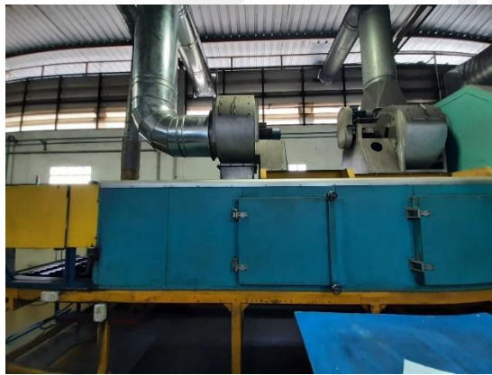
ภาพที่ 14 เข้าเครื่องอบสีเป็นเวลา 20-25 นาทีเพื่ออบสีให้สุก
