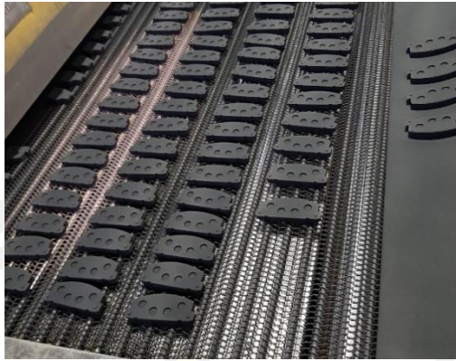
ภาพที่ 13 ชิ้นงานออกจากเครื่องฟั่นสีและเข้าเครื่องอบสี
