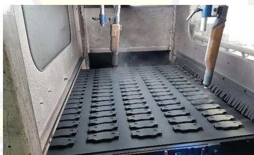
ภาพที่ 12 พ่นสีชิ้นงานที่จัดเรียงลงบนสายพาน
