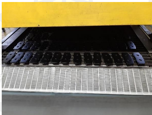
ภาพที่ 15 ชิ้นงานเคลื่อนที่ออกจากตู้อบสีเพื่อไปยังกระบวนการถัดไป
