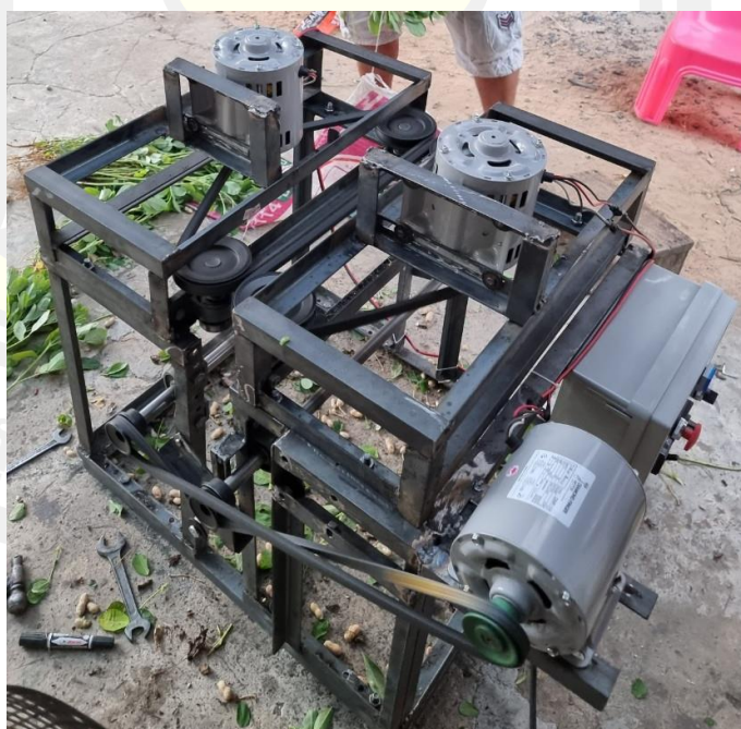
ภาพประกอบ 13 แสดงเครื่องเก็บเกี่ยวถั่วลิสงด้วยระบบมอเตอร์ไฟฟ้าเกลิยววน
