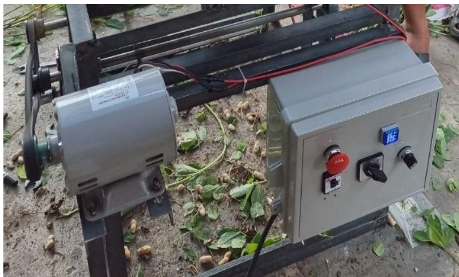
ภาพประกอบ 16 แสดงส่วนควบคุมไฟฟ้า
