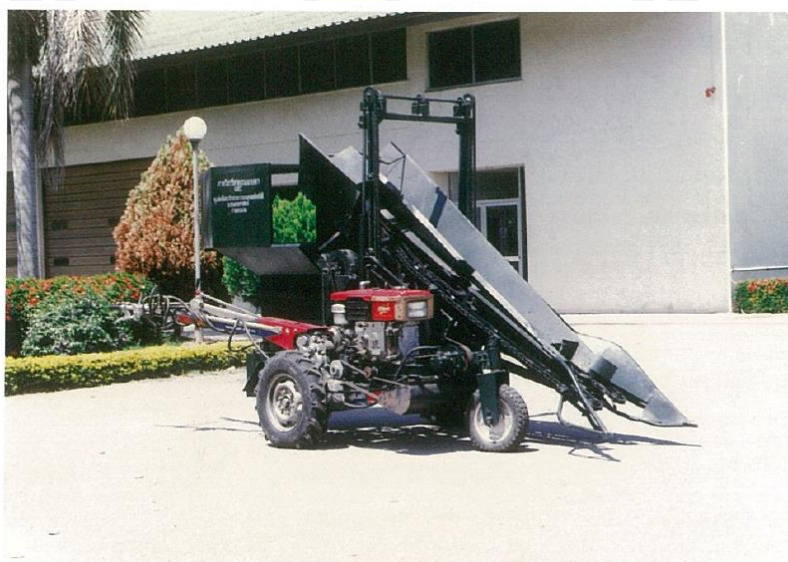
ภาพประกอบ 2 เครื่องเก็บเกี่ยวข้าวโพดติดรถไถเดินตาม [24]
