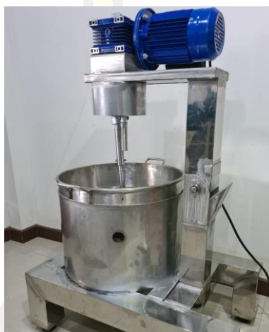
ภาพประกอบ 2 เครื่องกวนสารแบบใบพัดสำหรับการใช้ของสารที่มีความหนืดสูง [4]
