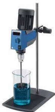
ภาพประกอบ 3 เครื่องกวนสารแบบใบพัดสำหรับใช้งานด้านวิทยาศาสตร์และการแพทย์ [5]
