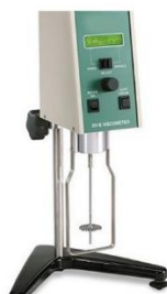
ภาพประกอบ 23 เครื่องวัดความหนืดของเหลวแบบดิจิทัล [16]
