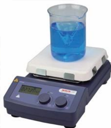
ภาพประกอบ 4 เครื่องกวนสารแบบแท่งแม่เหล็ก [6]
