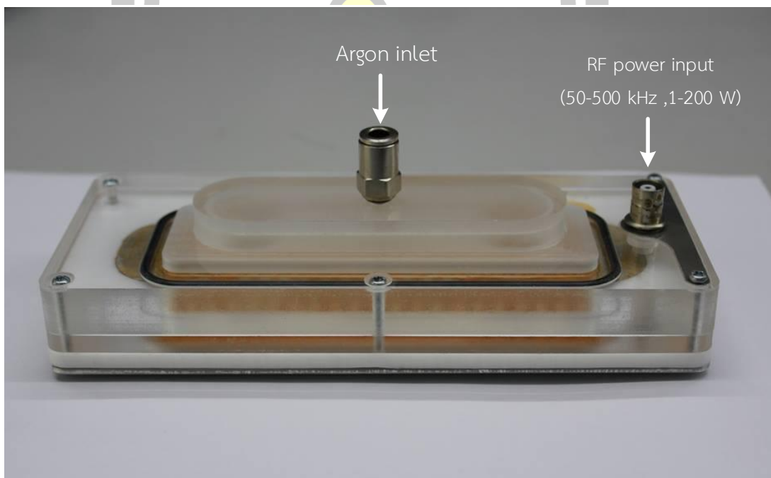
ภาพที่ 3.6 ชิ้นงานจริงหลังการประกอบที่มีการติดตั้งข้อต่อแก๊ส และข้อต่อหัว RF Power
