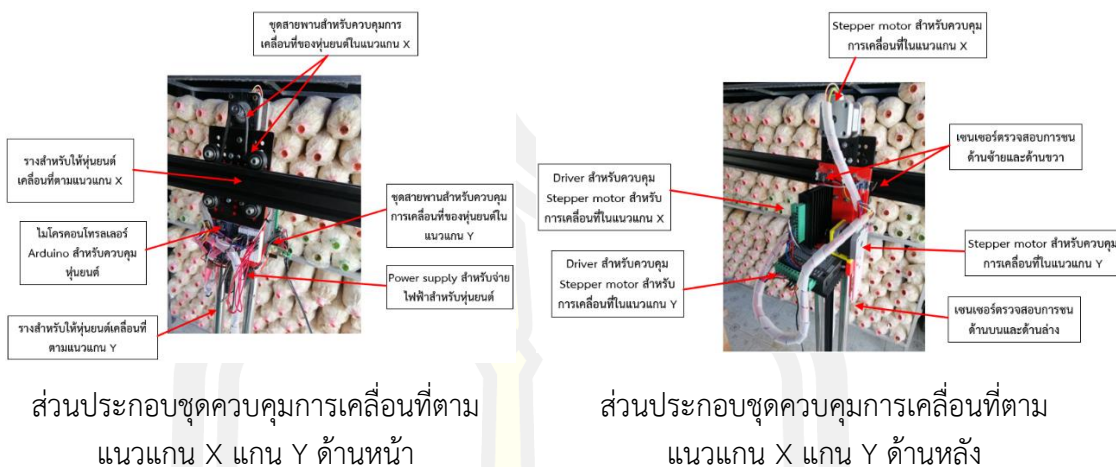
ภาพที่ 4.1 ส่วนประกอบชุดควบคุมการเคลื่อนที่ด้านหน้า-ด้านหลัง
