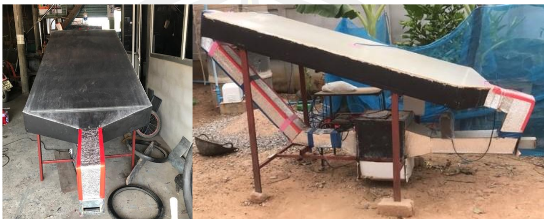
ภาพประกอบ 3.14 เครื่องอบแห้งพลังงานแสงอาทิตย์ร่วมกับรังสีอินฟราเรดสำหรับอบแห้งไพล
