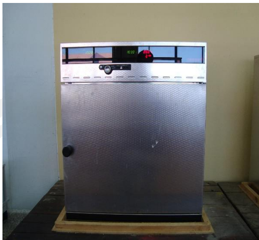
ภาพประกอบ ง-2 ตู้อบไฟฟ้าที่ใช้สำหรับหาความชื้น
