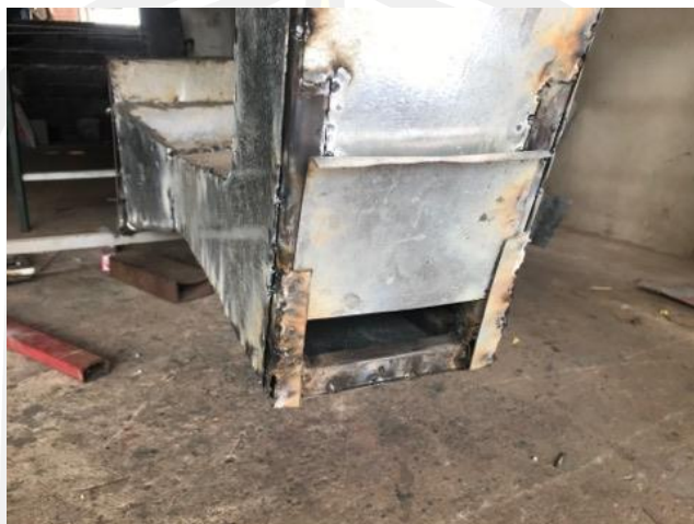
ภาพประกอบ 3.12 ระบบนำความร้อนกลับคืนมาใช้ใหม่สัดส่วน 70%
