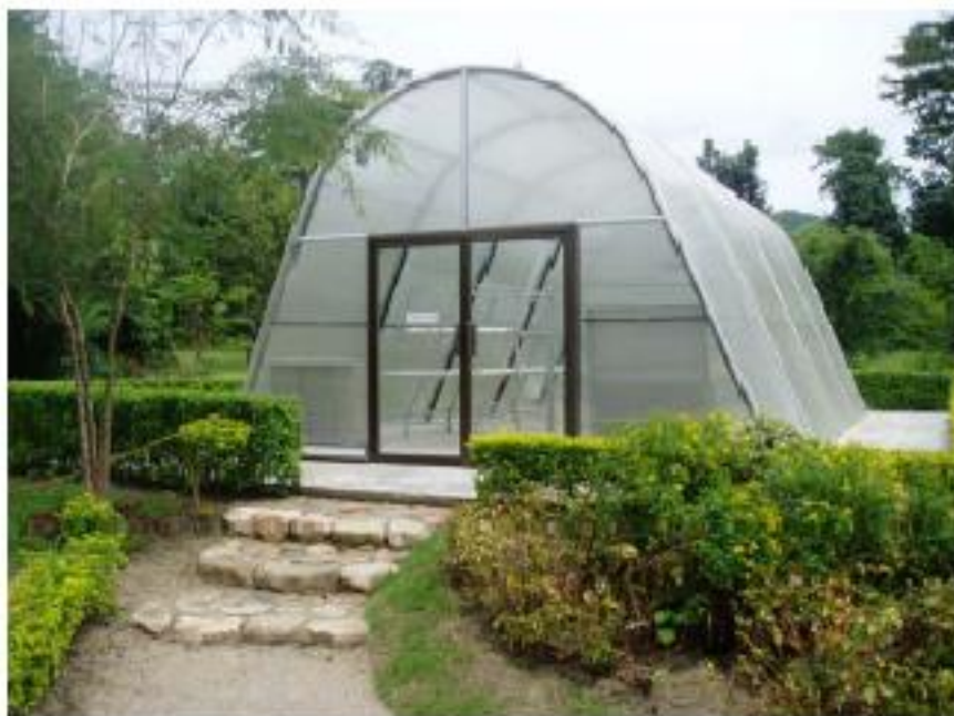
ภาพประกอบ 2.2 เครื่องอบแห้งแบบรับแสงอาทิตย์โดยตรงชนิดอุโมงค์หลังคาโค้ง [13]
