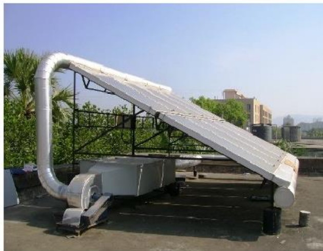
ภาพประกอบ 2.5 เครื่องอบแห้งแบบใช้แผงรับความร้อนโดยใช้พัดลมดูดอากาศร้อนเพื่อลดความชื้น ของผลิตภัณฑ์ [13]
