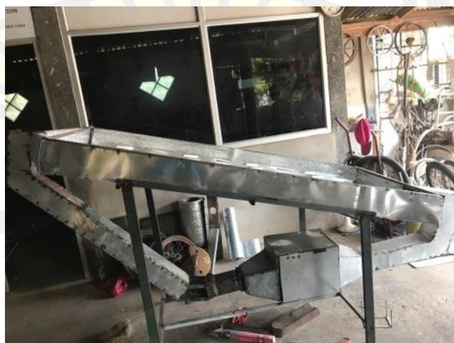
ภาพประกอบ 3.11 การประกอบเครื่องอบแห้งพลังงานแสงอาทิตย์ร่วมกับกังหันสีอินฟราเรด
