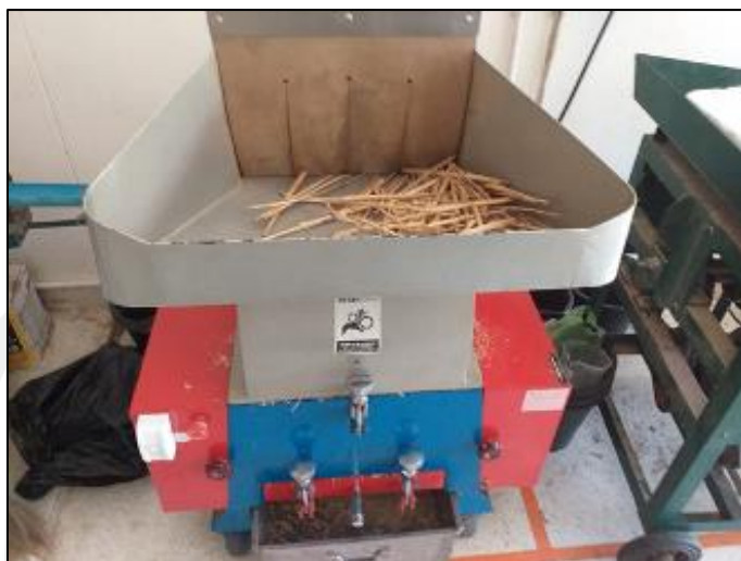
ภาพประกอบที่ ง-3 การบดหญ้าด้วยเครื่องบดแบบละเอียด
