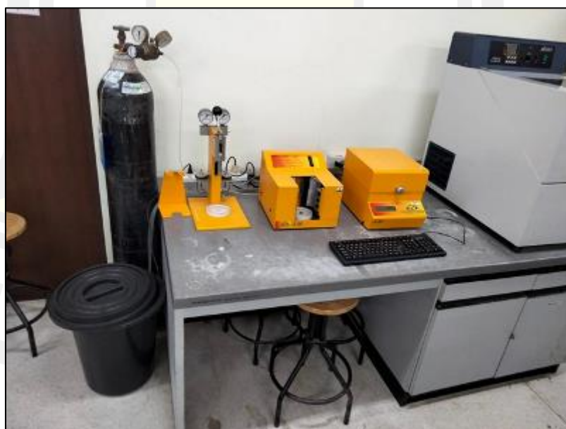
ภาพประกอบที่ ง-8 การหาพลังงานความร้อนของวัสดุดูดซับด้วย Bomb Calorimeter
