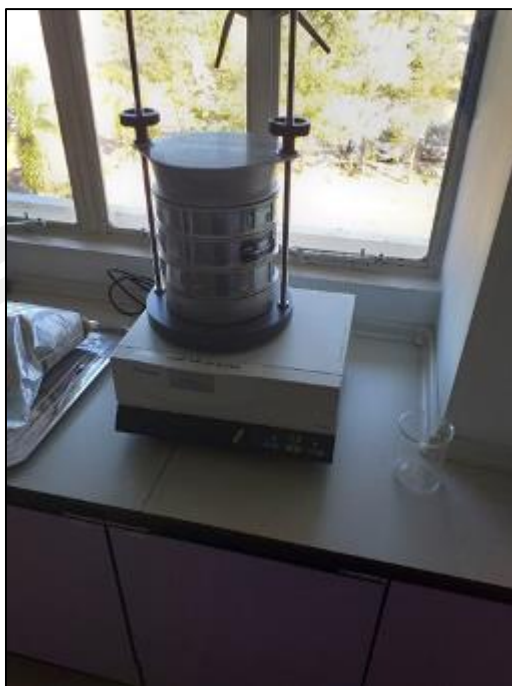
ภาพประกอบที่ ง-5 การแยกขนาดหญ้าด้วยเครื่องเขย่าตะแกรง
