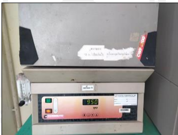
ภาพประกอบที่ ง-10 การเผาหว่านด้วยเตาเผาอุณหภูมิสูง
