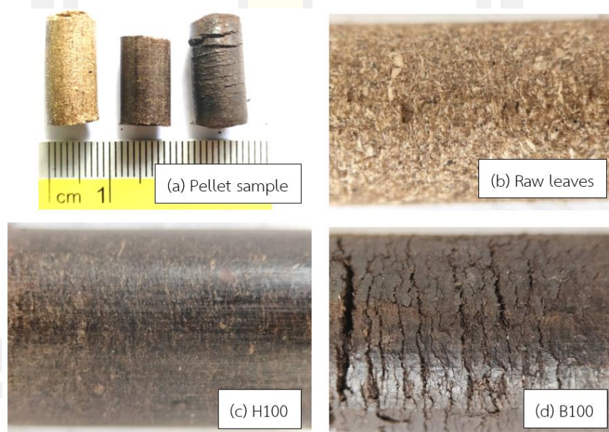
ภาพประกอบที่ 4.14 ลักษณะพื้นผิวภายนอกของชีวมวลไบอ้อย ไฮโดรชาร์และไบโอชาร์อัดเม็ด
