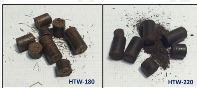
ภาพประกอบที่ 2.12 การแตกหักของเชื้อเพลิงอัดเม็ดเมื่อปรับสภาพที่อุณหภูมิสูง [20]
