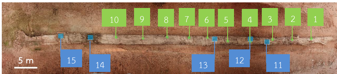
ภาพที่ 43 ตำแหน่งของแบบจำลองสามมิติที่นำมาวิเคราะห์หาความเปลี่ยนแปลงของพื้นผิว สีฟ้า) บริเวณที่เป็นส่วนของตาไม้และรอยแตก สีเขียว) บริเวณลำต้นที่มีพื้นผิวเรียบ
