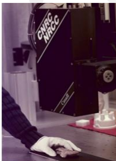
ภาพที่ 6 การใช้เครื่องเลเซอร์สแกนชิ้นส่วนกะโหลกบริเวณ basisphenoid-basioccipital ของ Tylosaurus sp. ที่มา: (Lyons et al. , 2000)
