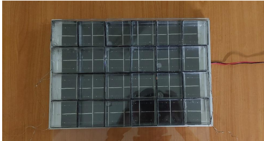
ภาพประกอบที่ 29 แสดงการใช้งานร่วมกันของโซล่าเซลล์โปร่งแสงและโซล่าเซลล์แบบผลึกทึบ
