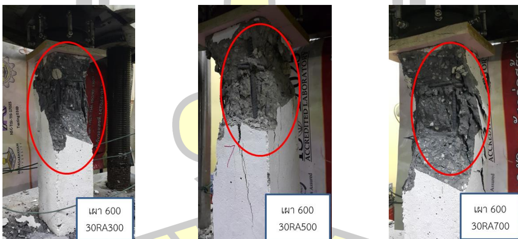
ภาพประกอบ 4.23 การวิบัติของเสาคอนกรีตหลังการเผาที่อุณหภูมิ 600 องศาเซลเซียส เป็นเวลา 2 ชั่วโมง ในปริมาณแทนที่ร้อยละ 30
