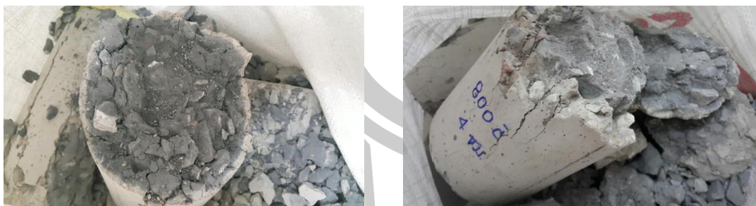
ภาพประกอบ 4.17 ลักษณะหลังการเผาคอนกรีตควบคุมทรงกระบอก
