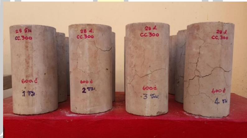
ภาพประกอบ 4.11 แสดงรอยร้าวหลังการเผาของคอนกรีตควบคุม
