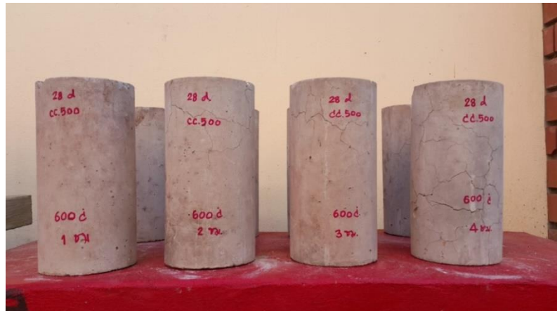
ภาพประกอบ 4.12 แสดงรอยร้าวหลังการเผาของคอนกรีตควบคุม CC 500 ขนาดเส้นผ่าศูนย์กลาง 0.10 เมตร. สูง 0.20 เมตรอายุ 28 วัน
