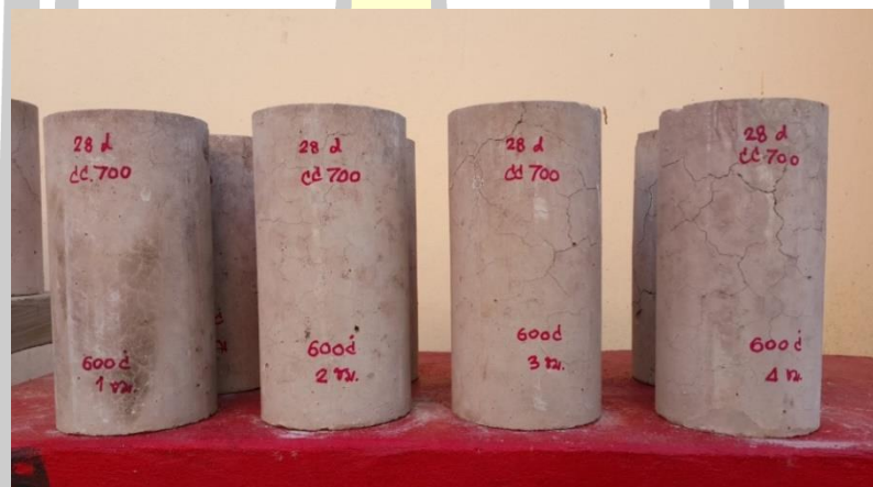
ภาพประกอบ 4.13 แสดงรอยร้าวหลังการเผาของคอนกรีตควบคุม CC 700 ขนาดเส้นผ่าศูนย์กลาง 0.10 เมตร. สูง 0.20 เมตรอายุ 28 วัน
