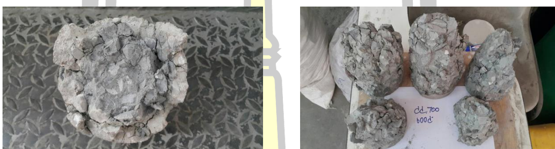
ภาพประกอบ 4.18 ลักษณะหลังการเผาคอนกรีตควบคุมทรงกระบอก
