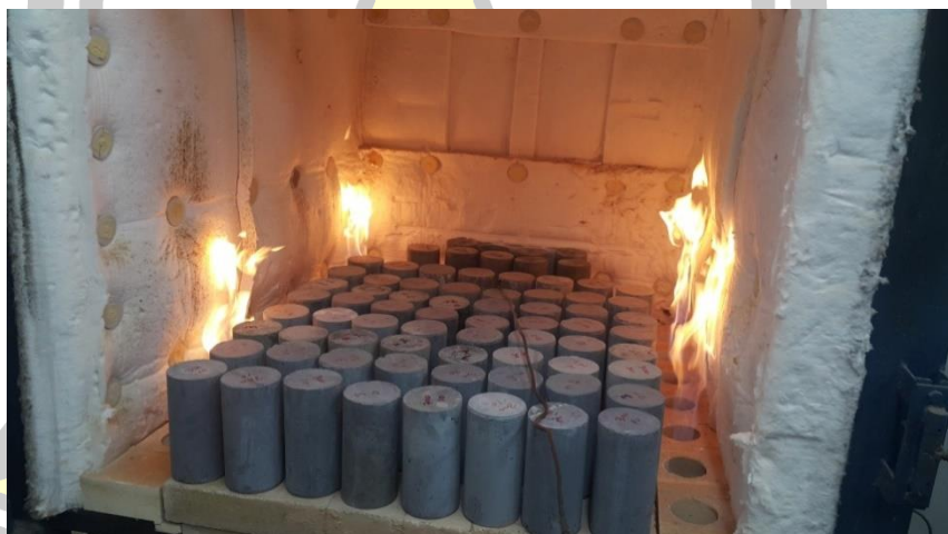
ภาพประกอบ 4.16 การเผาตัวอย่างคอนกรีต
