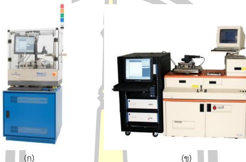
ภาพประกอบ 5.27 (ก) เครื่องมือวัด QST รุ่น BLAZER-X5 สำหรับหัวอ่านข้อมูลในระดับบาร์ [171] (ข) เครื่องมือวัด QST รุ่น WLA-3000 สำหรับหัวอ่านข้อมูลในระดับเวเฟอร์ [172]
