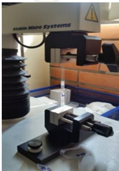
ภาพประกอบที่ 16 เครื่องทดสอบแรงดึง (TEXTURE ANALYZER)
