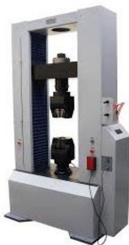
ภาพประกอบที่ 13 เครื่องทดสอบแรงดึง (TENSILE TESTING)
