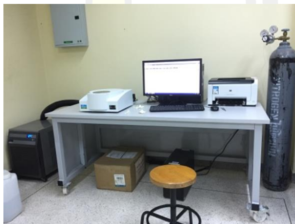
ภาพประกอบที่ 14 เครื่อง DIFFERENTIAL SCANNING CALORIMETER (DSC) รุ่น DSC-4000
