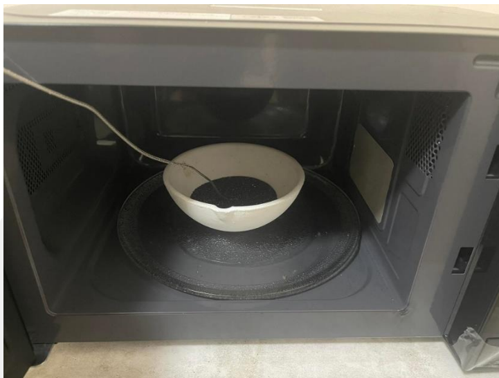
รูปภาพประกอบ 30 การวัดซิลิกอนคาร์ไบด์มวล 100 กรัม ในเตาไมโครเวฟ
