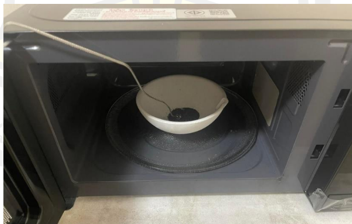
รูปภาพประกอบ 29 การวัดซิลิกอนคาร์ไบด์มวล 10 กรัม ในเตาไมโครเวฟ
