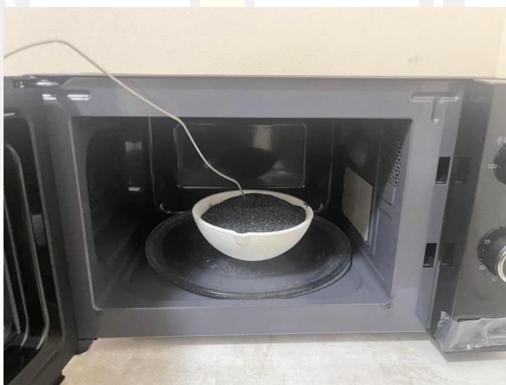
รูปภาพประกอบ 31 การวัดซิลิกอนคาร์ไบด์มวล 500 กรัม ในเตาไมโครเวฟ
