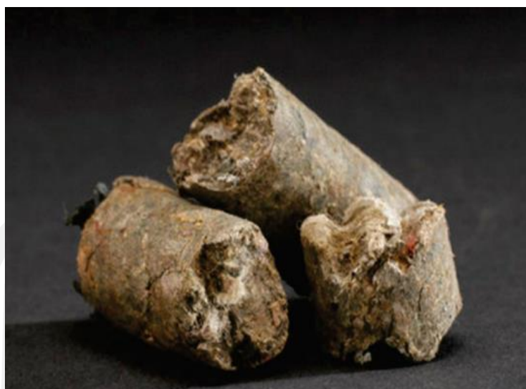
ภาพที่ 7 เชื้อเพลิงขยะ (Refuse Derived Fuel : RDF)
