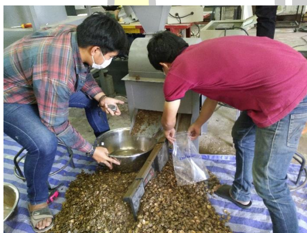
ภาพประกอบ ค.11 การทดสอบการทำงานของเครื่องกะเทาะฝักถั่วดาวอินคา
