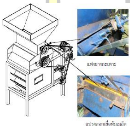
ภาพประกอบ 2.17 เครื่องกะเทาะลูกเด็ยขนาดเล็ก [19]
