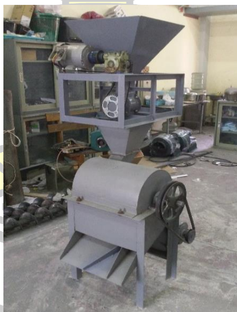
ภาพประกอบ ค.7 เครื่องกะเทาะฝักถั่วดาวอินคาเป็นเมล็ดน้ำตาล
