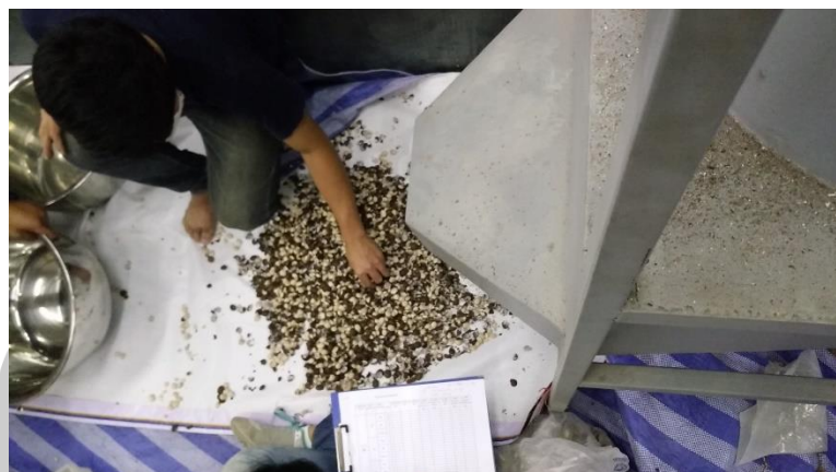
ภาพประกอบ ค.12 การทดสอบการทำงานของเครื่องกะเทาะเมล็ดน้ำตาล
