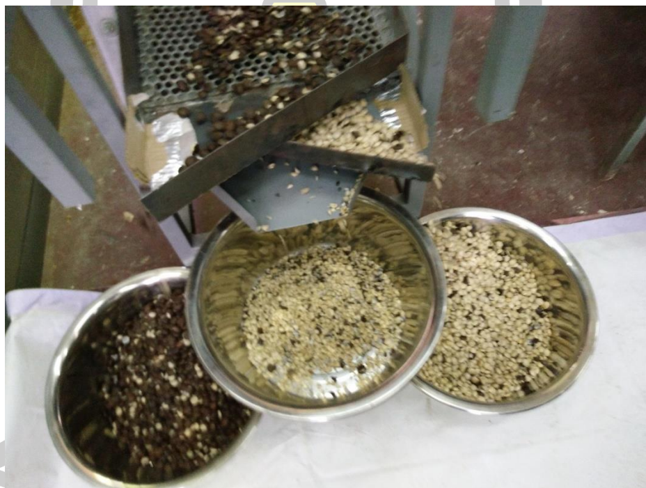
ภาพประกอบ ค.13 การทดสอบการทำงานของเครื่องทำความสะอาด
