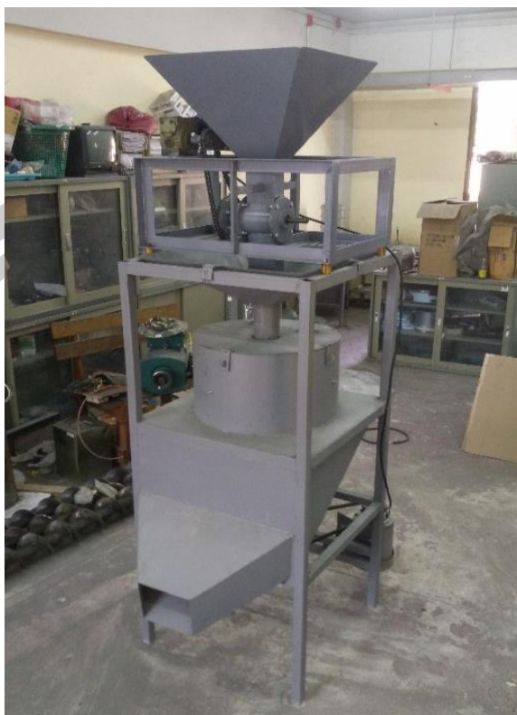
ภาพประกอบ ค.8 เครื่องกะเทาะเมล็ดน้ำตาลเป็นเมล็ดใน
