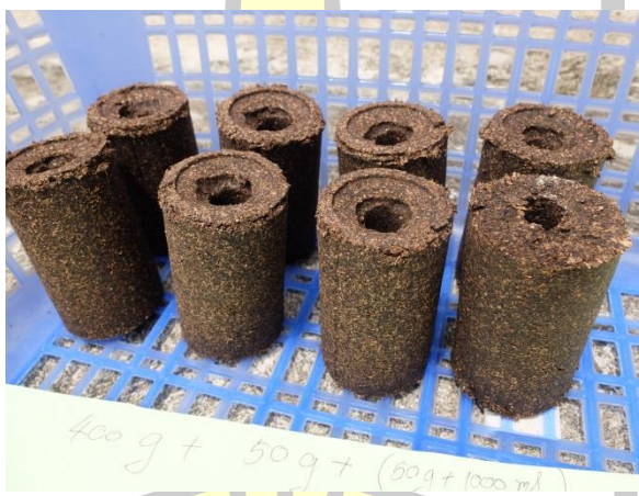
ภาพประกอบ 15 เชื้อเพลิงอัดแท่งที่มีส่วนผสมระหว่างกากเถ้าก๊วย ชี้เลื่อยและตัวประสานแป้งมันสำปะหลังเส้นผ่านศูนย์กลาง 5 เซนติเมตร เส้นผ่านศูนย์กลางของรูกลวง 1.5 เซนติเมตร ความสูง 10 เซนติเมตร
