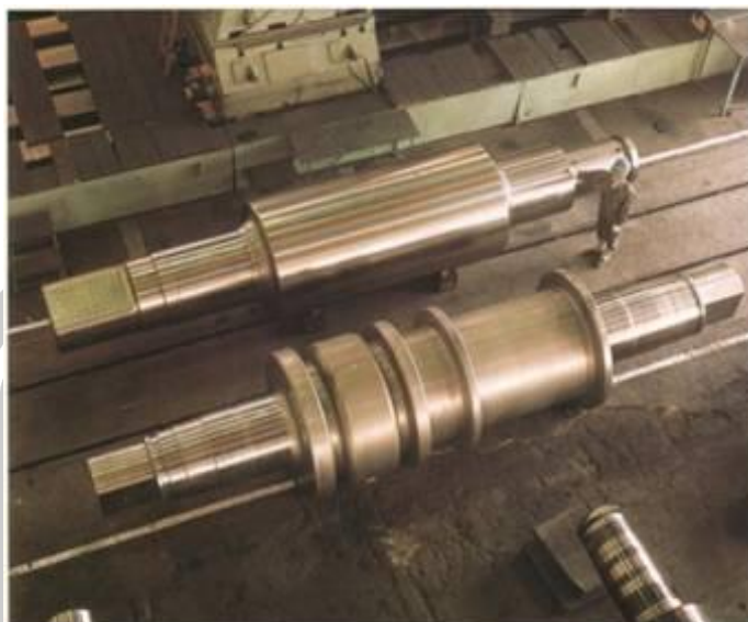
ภาพประกอบ 2 ลูกกรัดสำหรับกระบวนการรีดเหล็กกล้า [2]
