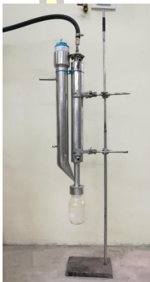
ภาพประกอบ 27 ชุดควบแน่นด้วยน้ำและชุดดักจับด้วยไฟฟ้าสถิต
