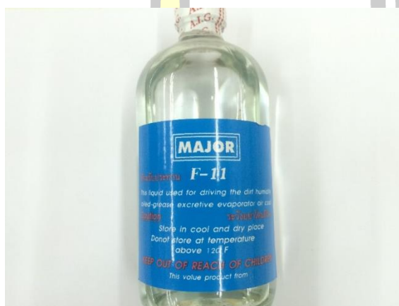
รูปภาพ 6 สารทำความเย็น R-11 ที่ใช้เป็นสารทำงานของท่อความร้อน
