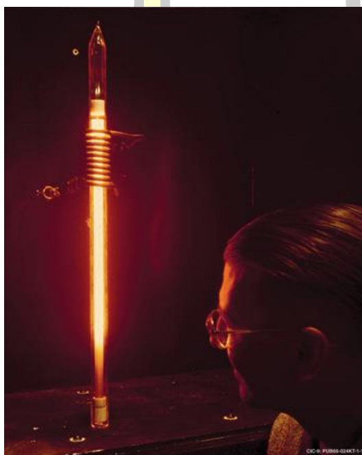
รูปภาพ 3 Grover ขณะทำการทดลองท่อความร้อน (Grover, 1966)
