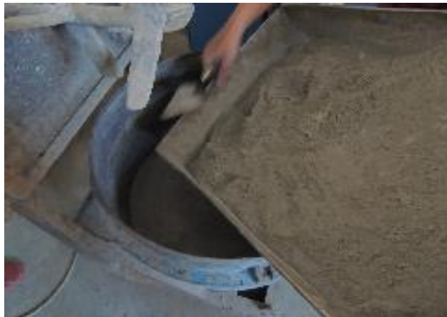
ภาพประกอบ 15 การนำปูนซีเมนต์ที่ผสมกับซิลิกาฟุ่มเทเข้าเครื่องผสม
