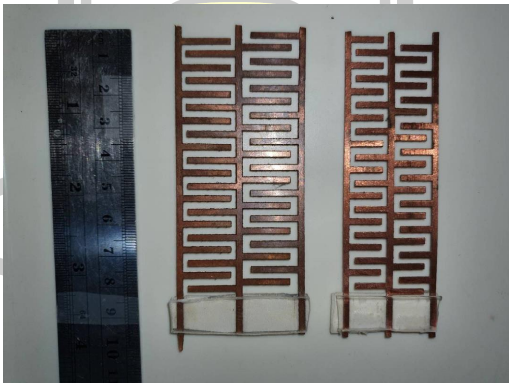
ภาพที่ 31 ตัวรับรู้ระดับของเหลวค่าการเก็บประจุอินเตอ์ดิจิทัล(FR4) 2 ข้างแบบมีฐานรอง
