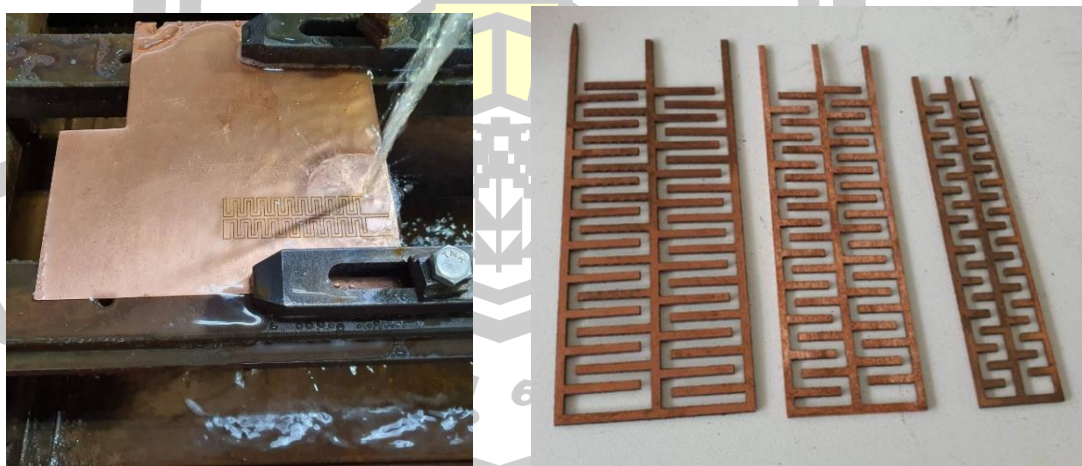
ภาพที่ 27 สร้างตัวรับรู้ระดับของเหลวค่าการเก็บประจุอินเตอร์ดิทัล 2 ทาง แบบไร้วัสดุฐานรอง
