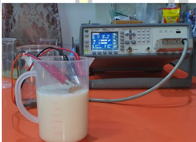
ภาพที่ 33 ตัวอย่างการวัดค่าความจุทางไฟฟ้าของน้ำมันดิบด้วยอินเตอร์ดิจิทัล 2 ทาง
