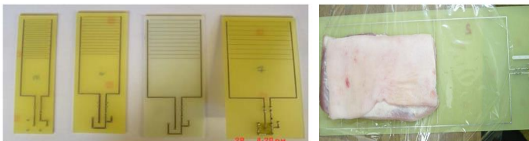
ภาพที่ 19 ตัวรับรู้ค่าการเก็บประจุอินเตอร์ดิจิทัลและการทดสอบวัดค่าอิมพีแดนซ์ของเนื้อหมู [23]
