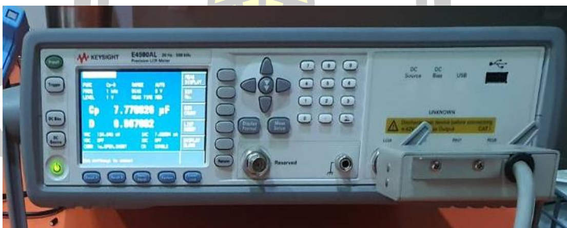
ภาพที่ 30 LCR Meter ยี่ห้อ KEYSIGHT รุ่น E4980AL
