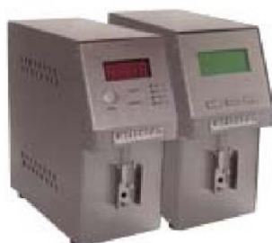
ภาพที่ 4 เครื่อง Cryoscope ของบริษัท Geneq, Inc รุ่น Lactoscan60 [9]
