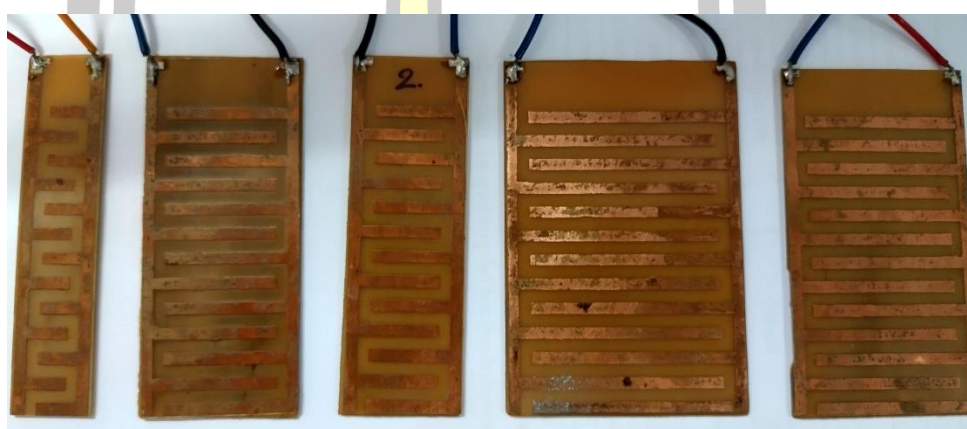
ภาพที่ 36 ตัวรับรู้ความขุ่นของน้ำแบบอินเตอร์ดิจิตอลคาปาซิเตอร์
