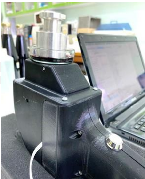
ภาพที่ 11 การวัดค่าการดูดกลืนของน้ำเฝ้า และไวน้เฝ้าด้วยเครื่องวิเคราะห์ฯ ที่ถูกพัฒนาขึ้นจากห้องปฏิบัติการ Near Infrared
