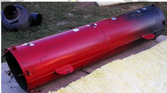
ภาพประกอบ 28 ห้องเผาไหม้ตัดแปลงจากถังขนาด 48 ลิตร
