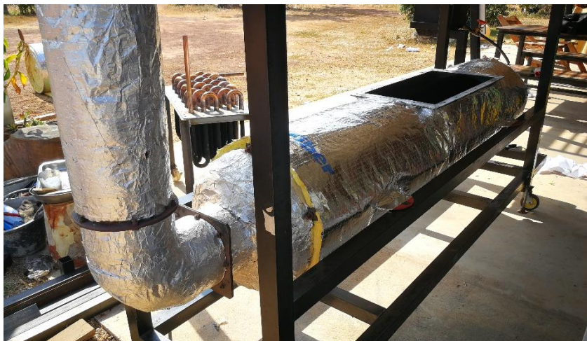
ภาพประกอบ 31 แท่นติดตั้งและทดลองเครื่องแลกเปลี่ยนความร้อนในเตาเผาแบบแนวนอน สำหรับผลิตไอน้ำความดันต่ำ
