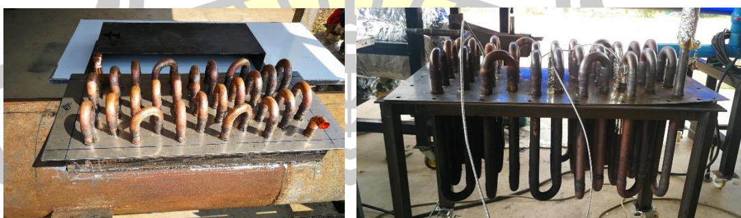
ภาพประกอบ 29 ชุดทดลองท่อแลกเปลี่ยนความร้อน
