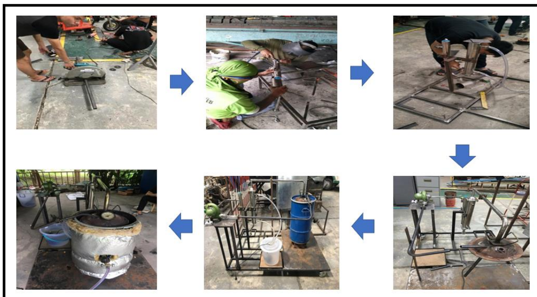
ภาพประกอบ 11 ขั้นตอนการสร้างเครื่องเผาเกลือโดยกระบวนการทอรีรีแฟกซ์แบบเบตนึ่ง
