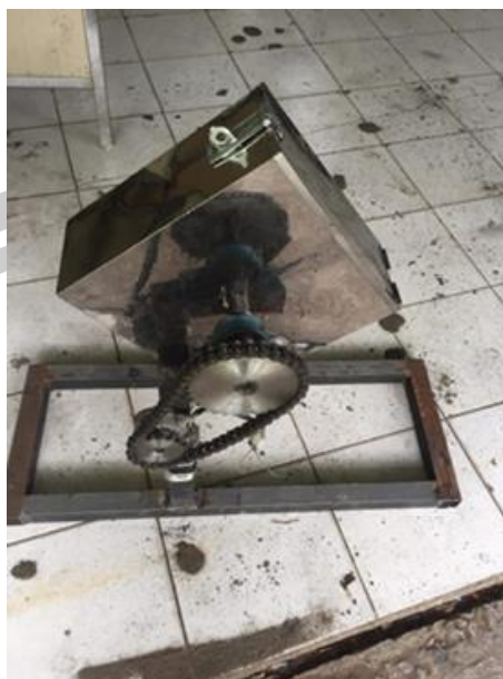
ภาพประกอบ 15 เครื่องทดสอบความทนทานเชื้อเพลิงอัดเม็ด
